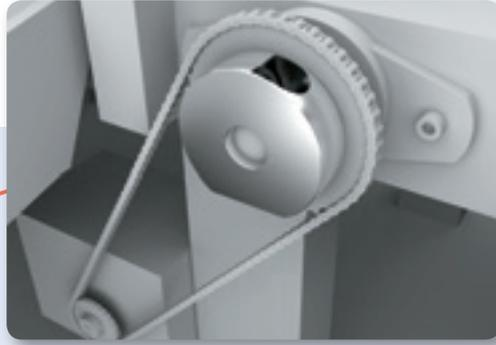
将不锈钢规格的 ETP 轴锁止用于食品加工机。
