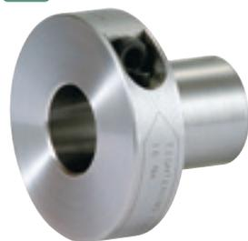
只需 1 根螺栓就能简单·迅速完成轴毂连接。而且同心度非常出色，仅为 0.006mm，因此最适用于精度要求高、拆装频率高的部位。采用从径向紧固的结构，因此不占用作业空间。
