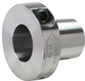
只需 1 根螺栓就能简单·迅速完成轴毂连接。而且同心度非常出色，仅为 0.02mm，因此最适用于精度要求高、拆装频率高的部位。采用从径向紧固的结构，因此不占用作业空间。
